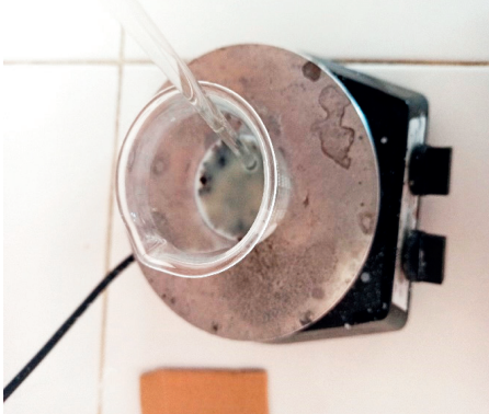
Figura 6. Fotografía del PET ámbar degradándose en la hidrólisis alcalina
