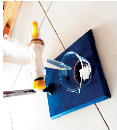
Figura 9. Fotografía de la neutralización con H_2SO_4 en el caso 3, de la botella PET ámbar.
