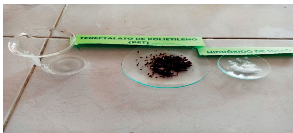
Figura 4. Fotografía del PET ámbar triturado e hidróxido de sodio listos para la hidrolisis alcalina
