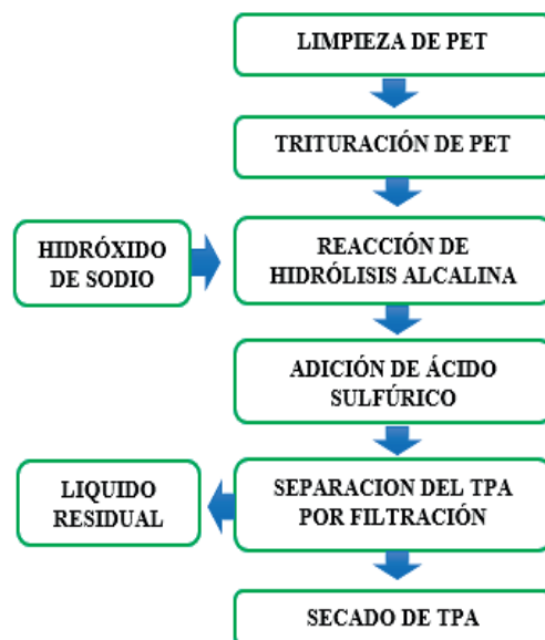
Figura 2. Procedimiento Hidrólisis alcalina de PET
