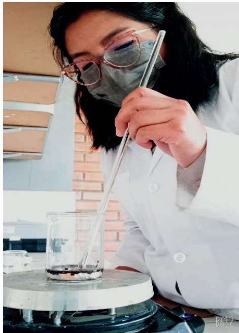
Figura 3. Fotografía de prácticas en laboratorio para obtención de TPA a partir de envases PET
