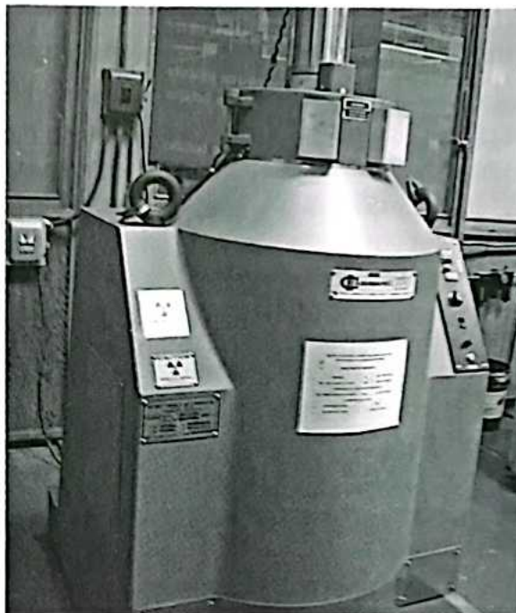
Foto 2. Irradiador de rayos gamma, Co-60 Tipo Gammacell - 220. (Victor H. Mendoza)
