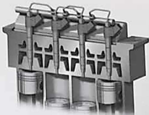
Figura 5. Esquema de funcionamiento básico de un sistema de inyección electrónica de combustible.
