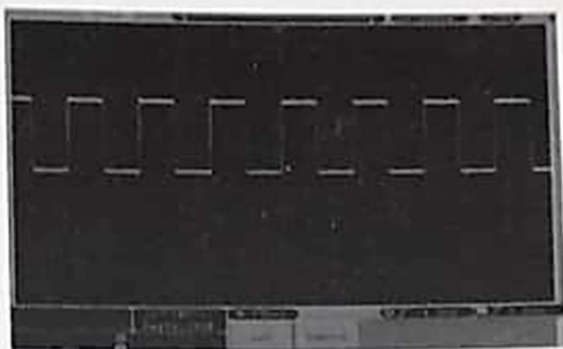
Fig. 5. Señal digital "IGF" del PCM, mostrada por un osciloscopio Fuente: Elaboración Propia
