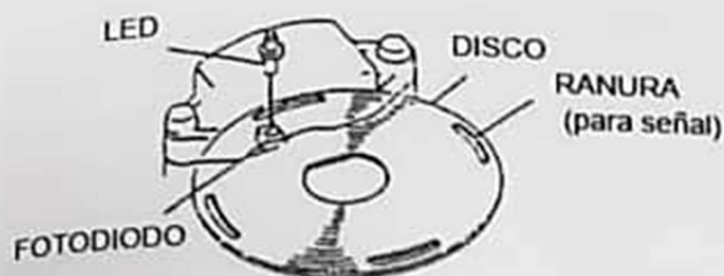
Figura 3. Sensor Óptico. Genera una señal digital para determinar la velocidad de giro del motor y la posición de los pistones y otra para que un módulo de control electrónico conecte y desconecte la bobina de encendido.
