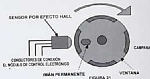
Figura 2. Sensor por efecto Hall. Genera una señal digital que interpreta el módulo electrónico para conectar y desconectar la bobina de encendido.
