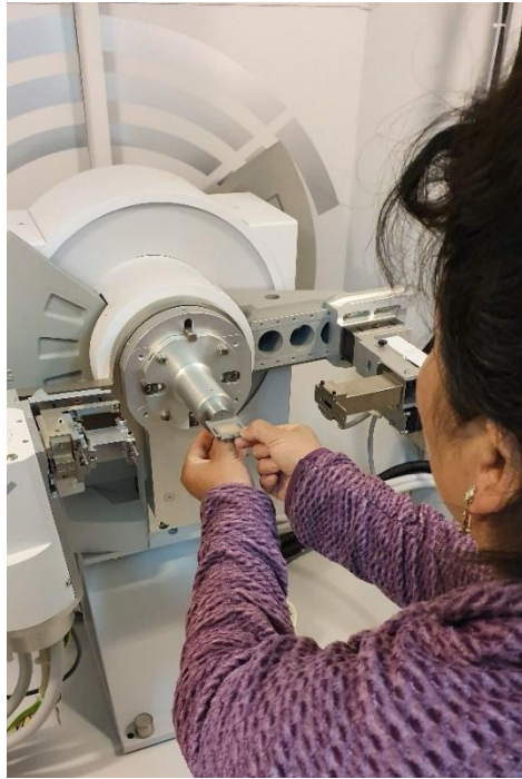
Foto16. Paso 5. Portamuestras en el equipo de DRX
