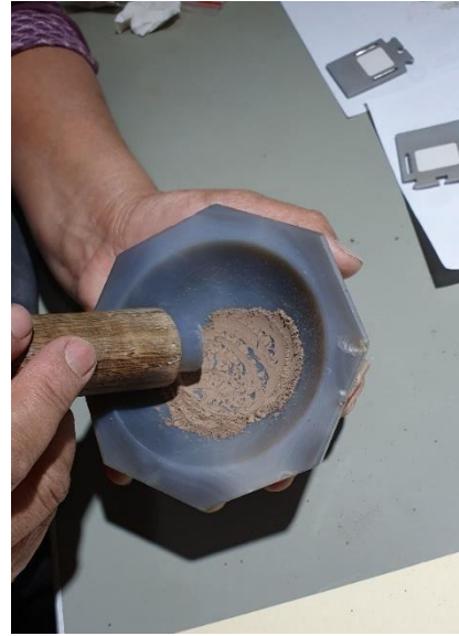
Foto 13. Paso 2. Molido a polvo fino del fracmento
