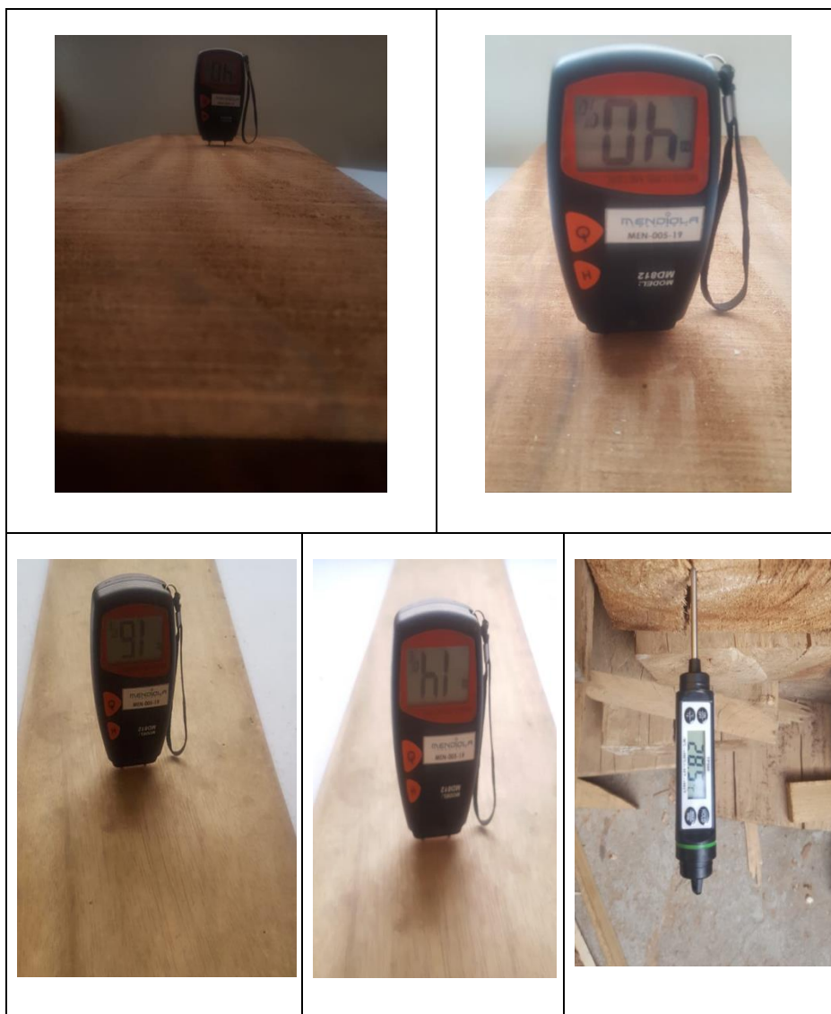
Figura 31: Mediciones realizadas a madera durante el proceso de secado al aire libre
