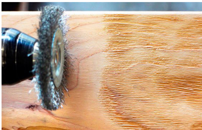
Figura 29: Proceso de cepillado de madera
