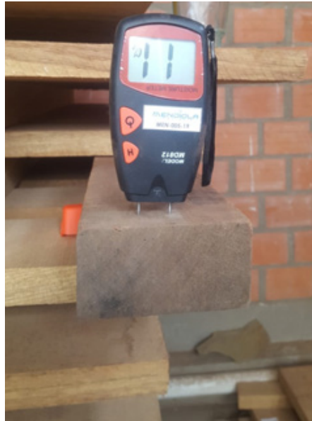
Figura 32: Medición realizada a madera seca en hornos industriales
