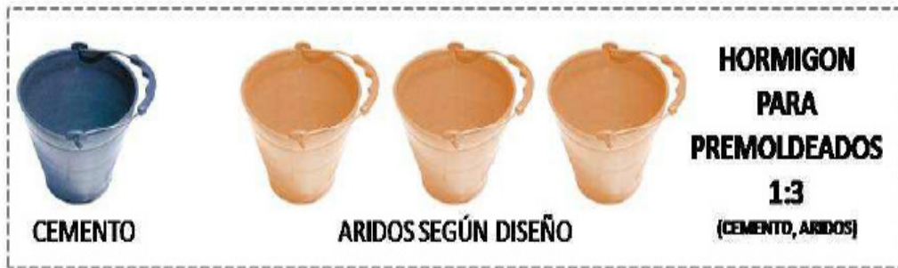
Figura 46. Esquema de proporcionalidad de dosajes
